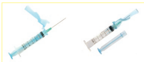
Рис. 2. Безопасный шприц SoloMed™ компании Becton Dickinson. После инъекции игла закрывается экраном, а поршень автоматически отламывается. Таким образом исключаются риски случайного укола иглой и повторного использования шприца
